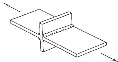
A : 荷重伝達型すみ肉溶接継手（非仕上げ）
