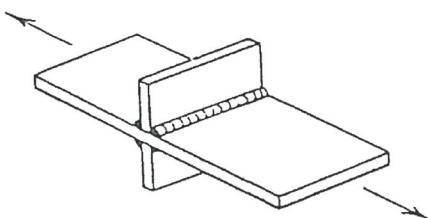
継手種類：荷重非伝達型すみ肉溶接継手（非仕上げ）
