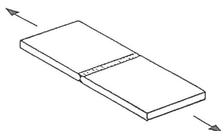
D : 余盛を削除した突合せ溶接継手
