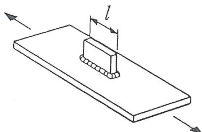
C : 面外ガセットをすみ肉溶接した継手
