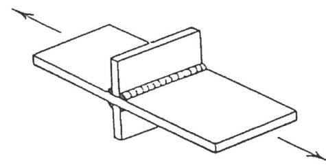
B : 荷重非伝達型すみ肉溶接継手（非仕上げ）
